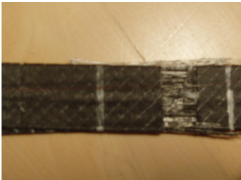
Figur 2. Typisk brott vid dragprovet.
