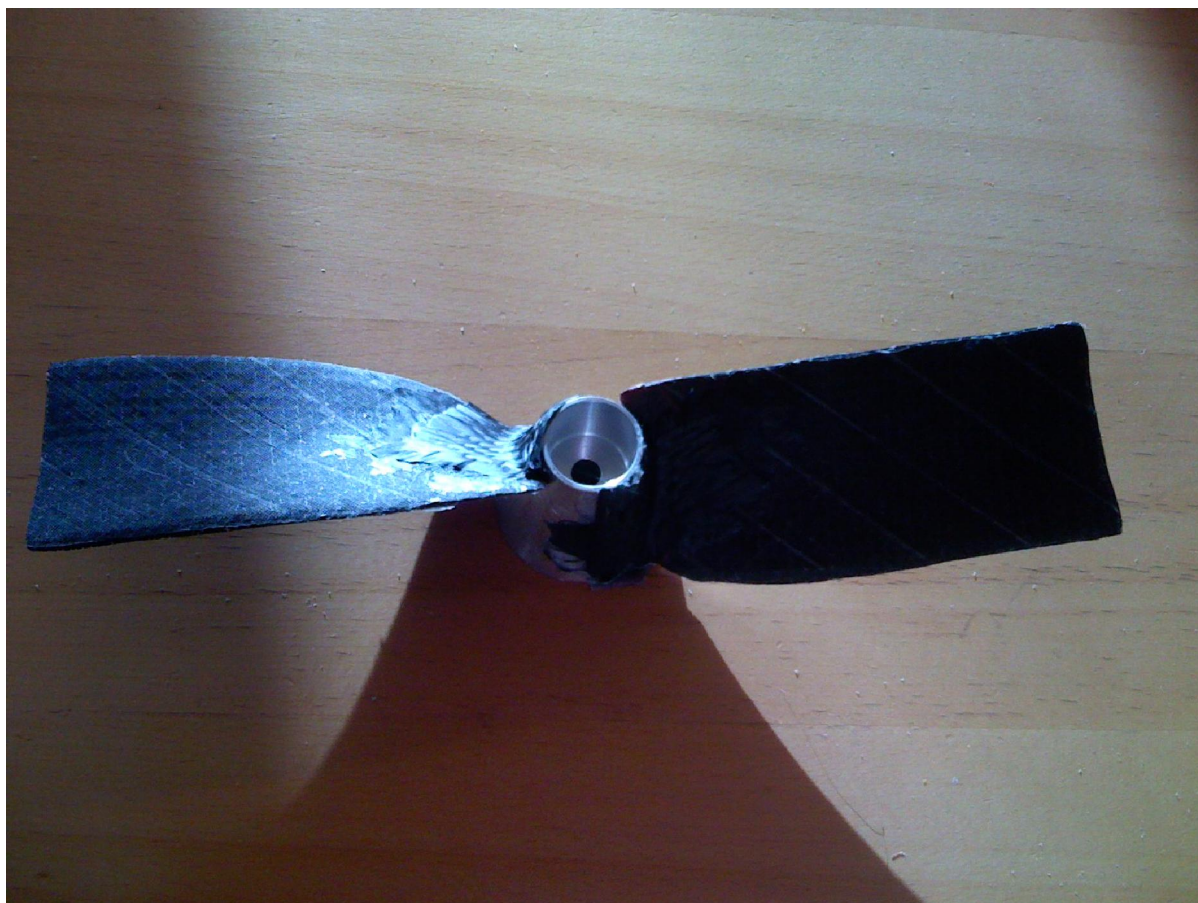
Figur 3 Propellerblad fixerade med kolfiberväv
