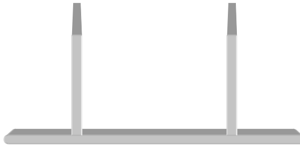
Figur 1. Det aktre bärplanet samt stödarmar approximerade som balkar
